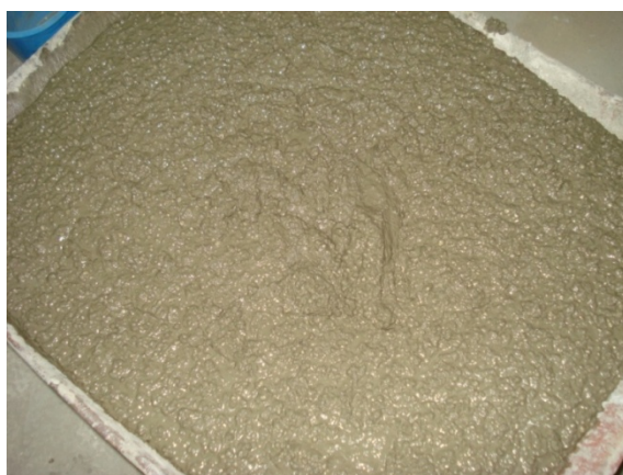
Fig. 02. - Concreto pronto para uso com densidade aparente de 1300 Kg/m 3 .
