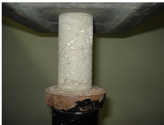
Fig.05 – Ensaio à compressão de um corpo-de-prova.
