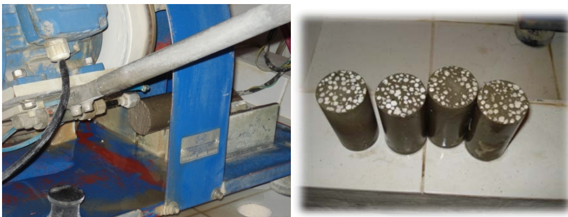
Fig. 04 - (a) – Corpos-de-prova sendo regularizados na retificadora. Fig.(b)- Corpos-de-prova prontos para o teste de compressão.
