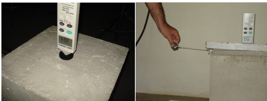
Fig. 07 – (a) Decibelímetro medindo som interno a caixa (b) Pêndulo para medida do ruído emitido através de percussão.
